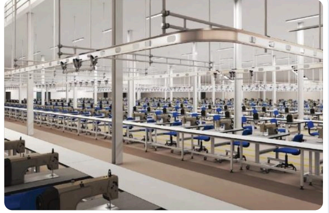
خط خياطة بمسار تعليق علوي Sewing hall with overhead hanging track
